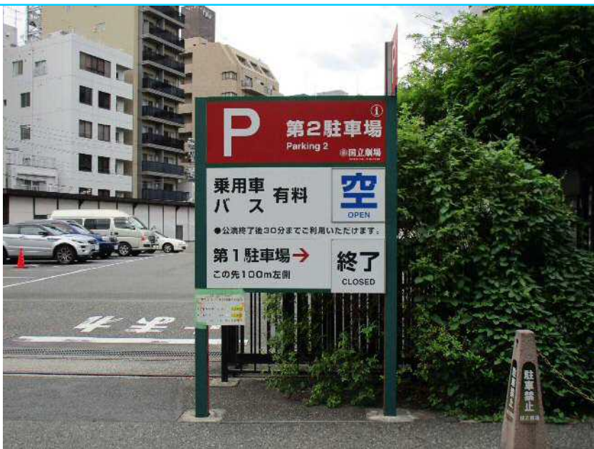
106 案内板 H=2.72m W=1.70m D=0.10m 支柱0.10m×0.10m スチール製 アクリル板
