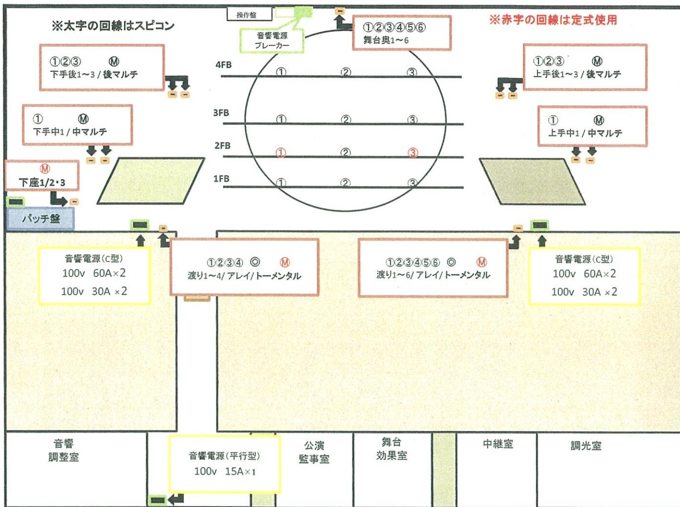
舞台下手袖パッチ盤(スピコン) ⇔ PA室 ステージアンプOUT 16回線(※定式にて2回線使用)
