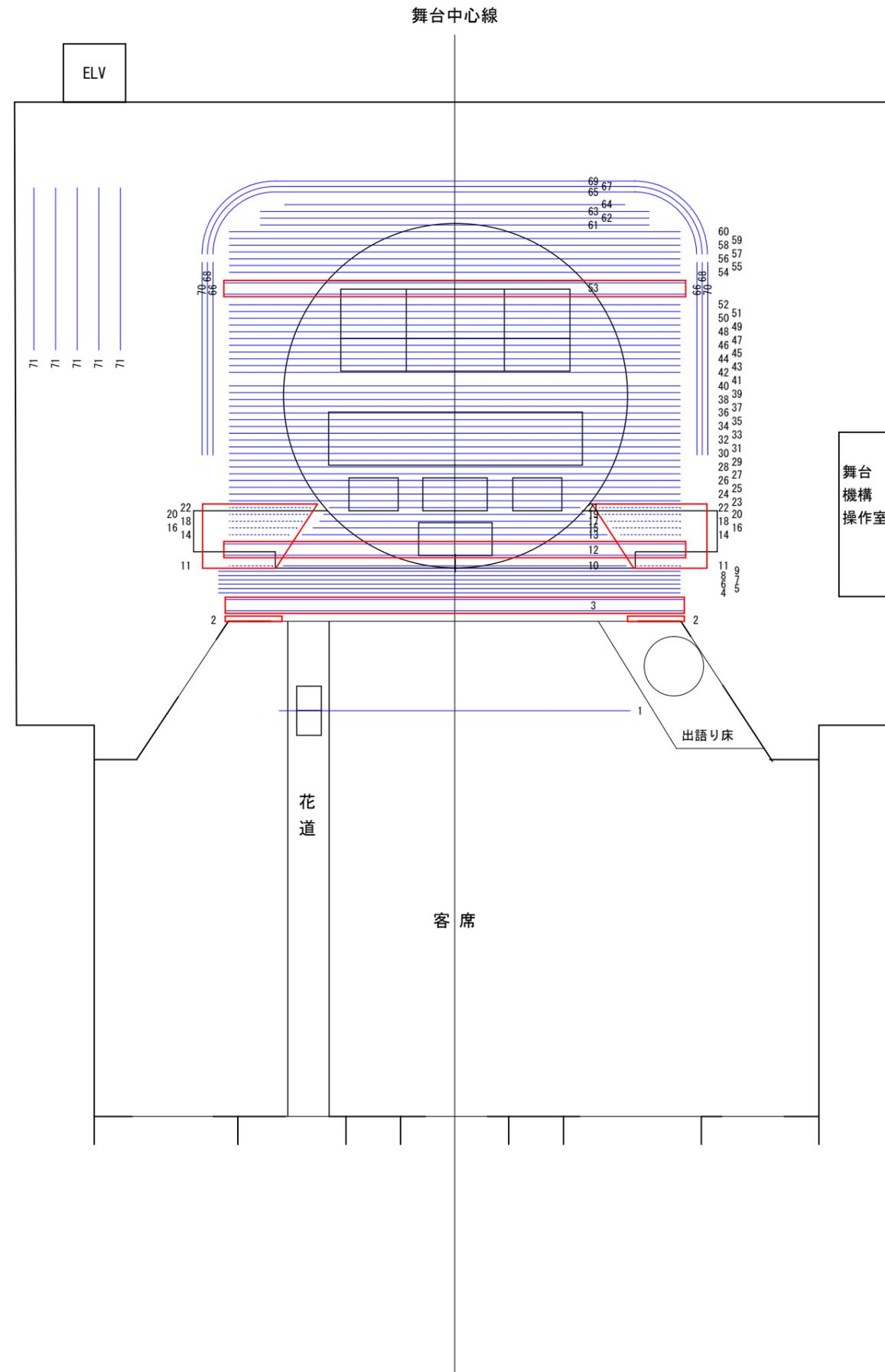
小劇場 吊物機構設備配置平面図
