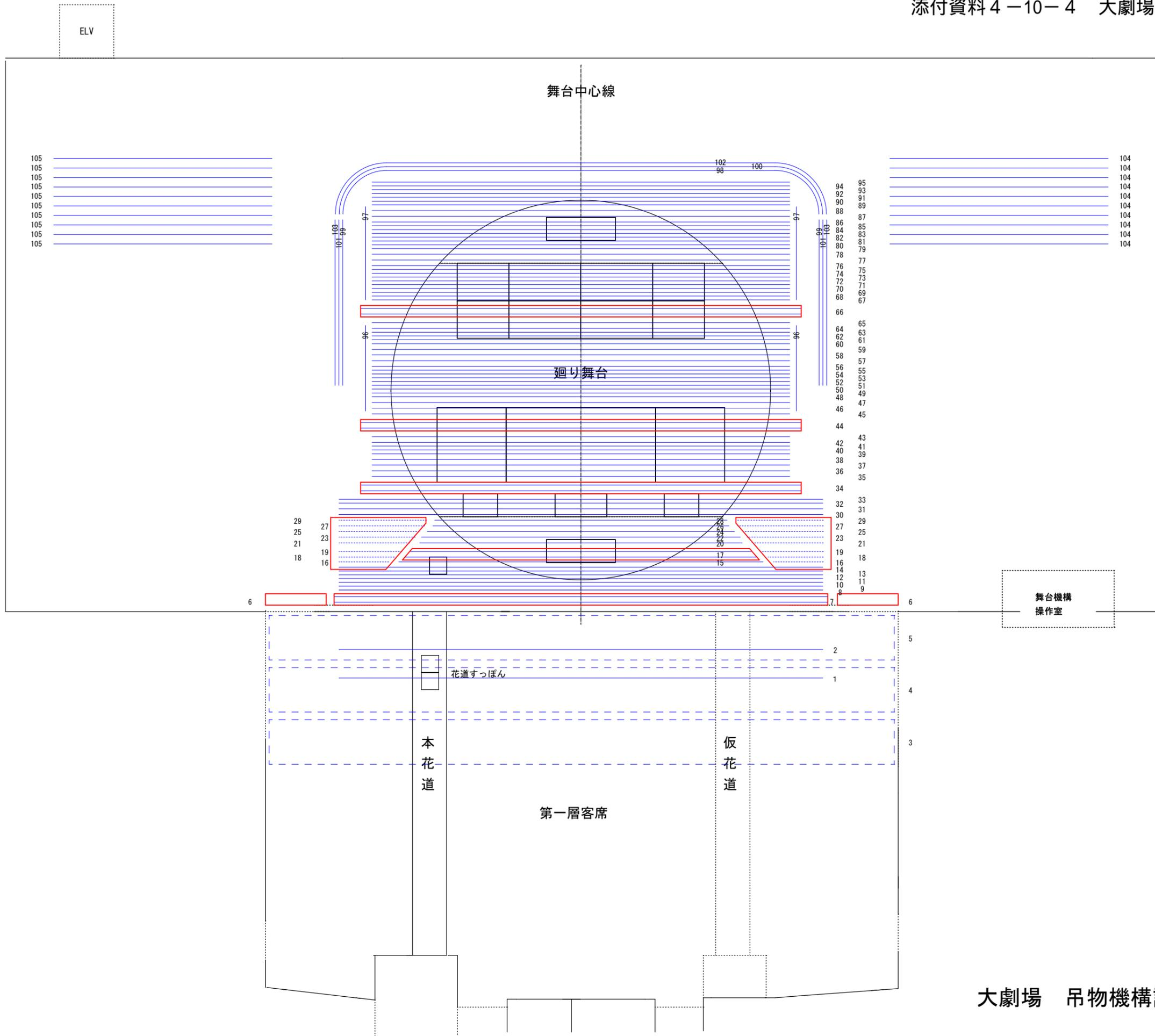
大劇場 吊物機構設備配置平面図
