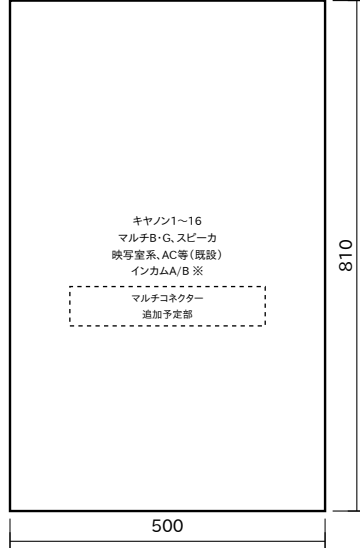
② 舞台袖上手袖コンセント盤 (舞台上手袖・自立箱型・奥行き250)
