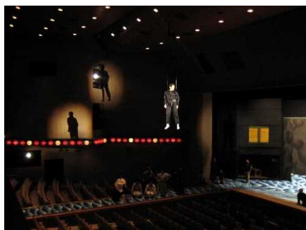
宙乗り機構 (試験走行・昇降風景)
